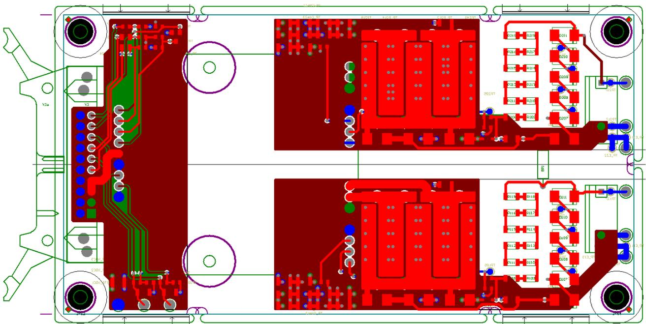
图 25 CONCEPT基板2BB0435T的PCB布局
