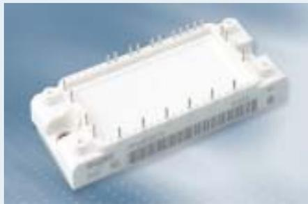
电路中的所有半导体功率器件集成在一个封装内，采用焊接技术安装
